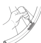
Fig. 8 — préventif injecté par la valve
