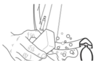
Fig. 5 — eau savonneuse sur les crochets et les tringles
