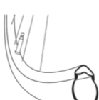
Fig. 6 — gonflage, tringles en place
